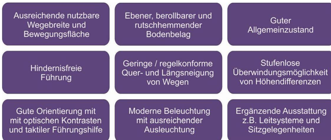
Bild 8-8: Übergeordnete Anforderungen an Barrierefreie Verkehrswege und Verkehrsanlagen
