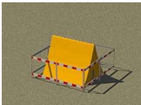
Bild 13: mobile Absturzsicherung mit 100mm Schrankenblatt und Zeltüberbau*
